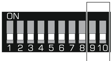
Rys. 2. Przełączniki służące do określenia trybu pracy kontrolera.
